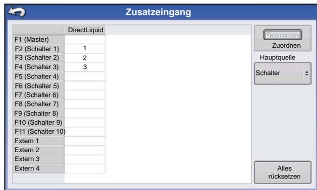
Die Schalterzuweisung-Funktion ist nur bei DirectCommand oder SeedCommand aktiv. Der Zusatzeingangeinstellungen-Bildschirm zeigt Einstellungen des Hauptschalters und anderer Schalter bei DirectCommand- oder SeedCommand-Einrichtungen.
