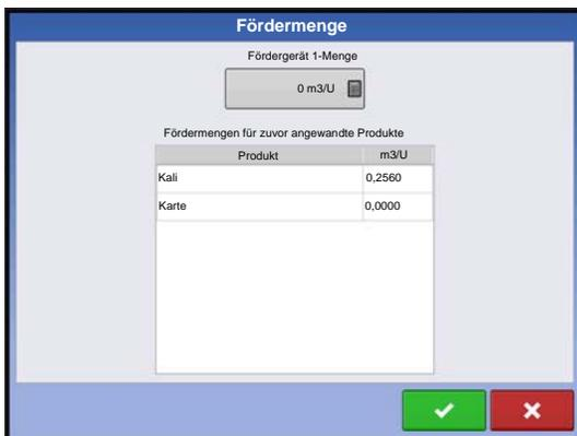
Die **Fördermenge-Schaltfläche** öffnet einen Bildschirm, in dem die Fördermenge eingegeben werden kann und eine Tabelle mit zuvor angewandten Produkten und Fördermengen angezeigt wird.
