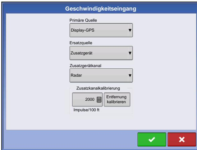
Im Geschwindigkeitseingangeinstellungen-Bildschirm kalibrieren Sie den Fahrgeschwindigkeitseingang, damit präzise Geschwindigkeits- und Flächenberechnungen möglich werden.
