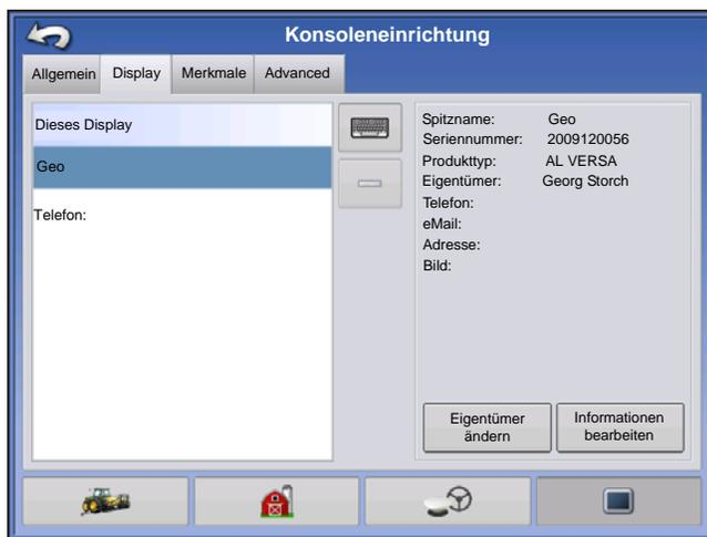
Das Display-Register enthält Funktionen zum Einrichten eines Displayeigentümers und zum Bearbeiten seiner persönlichen Daten. Die Displayeigentümer-Angaben werden im Produktausbringungsbericht der Ausbringungsmengensteuerung verwendet.
