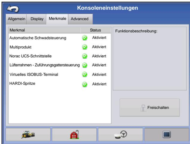
Im Funktionen-Register können Sie Freischaltcodes eingeben. Freischaltcodes werden speziell auf die Seriennummer des jeweiligen Displays und die Funktionsregistrierungsnummer abgestimmt. Diese Angaben müssen Sie Ihrem Händler übermitteln, wenn Sie Freischaltcodes erwerben möchten.
